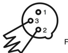
Le bouchon de terminaison réduit les erreurs de signal et évite les problèmes de transmission de signal et les interférences. Il est toujours recommandé de connecter un bouchon DMX (résistance 120 Ohm  $\frac{1}{4}$  W) entre la broche 2 (DMX-) et la broche 3 (DMX +) de la dernière unité.
